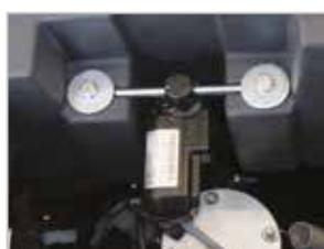
**Deux vérins dédiés** assurent la montée et la descente du bloc de lavage et du capteur
