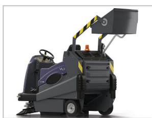
高位倾倒的垃圾斗，实现最大清扫效率
